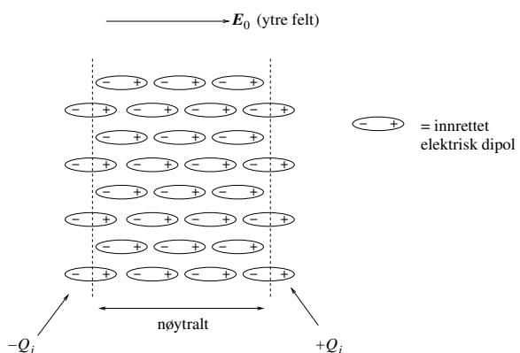
$\pm Q_i$  = indusert nettoladning på isolatorens overflater
