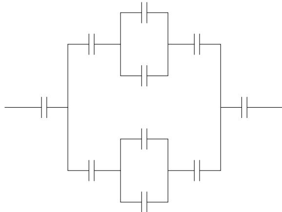
Hver av parallellkoblinene i midten har kapasitans  $2C$ , som i serie med to kapasitanser  $C$  gir i alt  $2C/5$ . To slike i parallel gir dermed  $4C/5$ , som endelig i serie med to stykker  $C$  gir  $4C/13$ .
