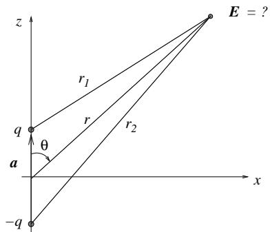
I oppgave 4 i øving 3 betraktet vi en elektrisk dipol, bestående av to punktladninger  $\pm q$  lokalisert på  $z$ -aksen i  $z = \pm a/2$ . Vi viste at potensialet  $V$  i stor avstand ( $r \gg a$ ) fra dipolen er tilnærmet lik
