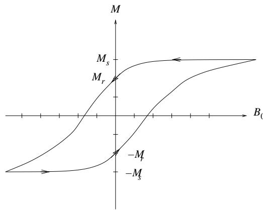
Formen på hysteresekurven vil nå avgjøre om det er snakk om en såkalt "hard magnet" (dvs en permanentmagnet) eller en "bløt magnet" (f.eks. et stykke stål):
