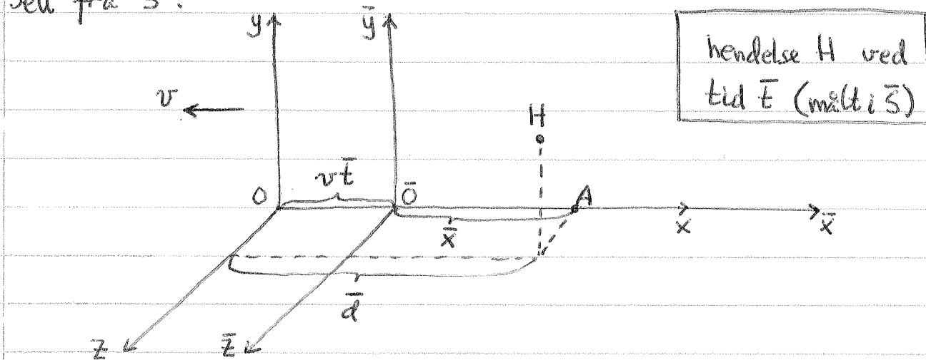
$\left. \begin{array}{l} \bar{d} = \bar{O}\bar{A} \text{ målt i } \bar{S} \\ d = OA \text{ målt i } S \end{array} \right\} \Rightarrow x = \frac{\bar{d}}{\sqrt{1-v^2/c^2}} = \gamma \bar{d}$
