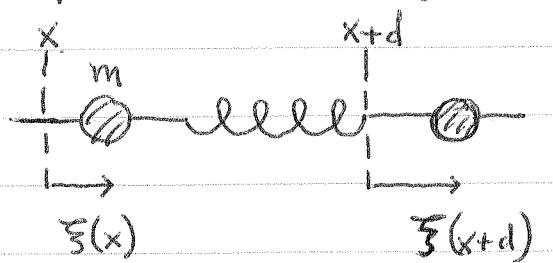
Vi har masse  $m$  på lengden  $d + S(x+d) - S(x) \approx d \left(1 + \frac{\partial S}{\partial x}\right)$
