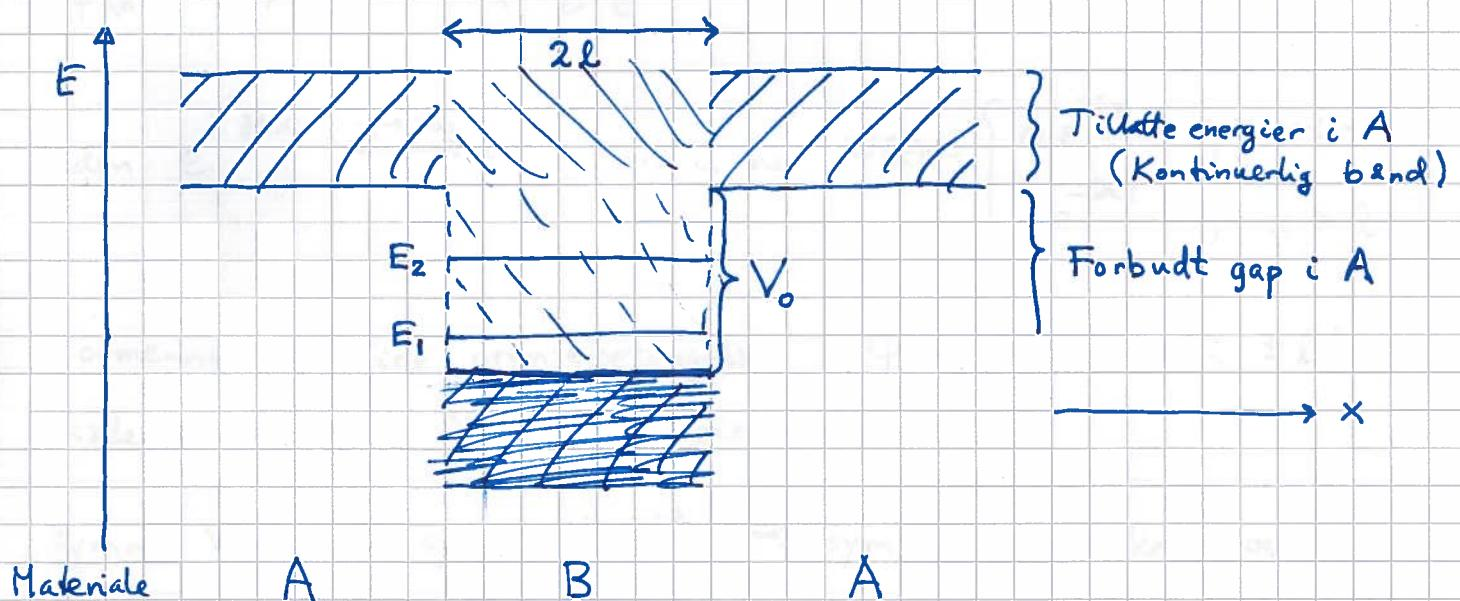
Med et tynt lag av materiale B kan vi få diskrete energinivåer  $E_1, E_2, \dots$  under det tillatte energibåndet i materiale A. Vi får essensielt et potensial  $V(x)$  som er  $V_0$  høyere i A enn i B :
