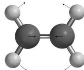
Vi ser at denne vibrasjonen *ikke* tilsvarer en oscillerende elektrisk dipol – molekylets elektriske dipolmoment er null underveis i hele vibrasjonsbevegelsen. Denne moden eksisteres dermed ikke av det oscillerende elektriske feltet i den innkommende elektromagnetiske bølgen.
