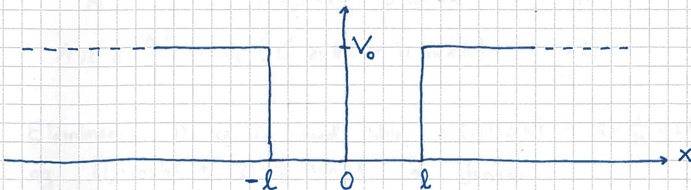
$$\text{dvs } V(x) = \begin{cases} 0 & ; |x| < l \\ V_0 & ; |x| > l \end{cases}$$
