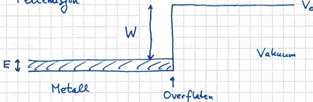
$W = V_0 - E$  = frigjøringsarbeidet (for elektronene med høgest energi,  $E$ , i metallet)
