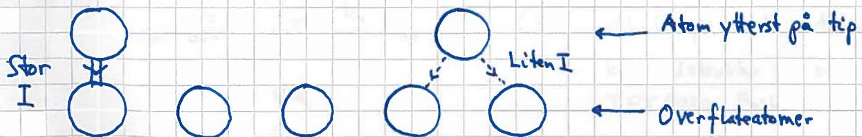
Strøm  $I \sim T \sim \exp(-2\beta e L)$  størst når tip-atom rett over (dvs nærmest) overflateatom.
