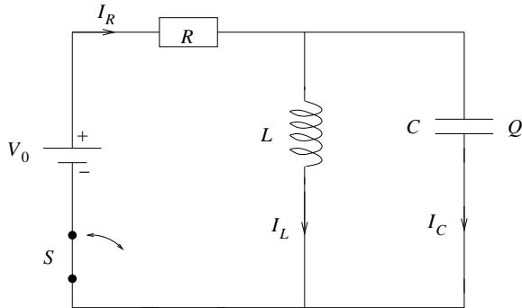
a) Anta først at bryteren  $S$  har vært lukket i lang tid slik at  $V_0$  har vært tilkoblet så lenge at vi har *stasjonære* forhold i kretsen (dvs tidsuavhengige strømstyrker). Bestem strømmene  $I_R$ ,  $I_L$  og  $I_C$  som angitt i figuren over. Bestem også ladningen  $Q$  på kondensatoren.
