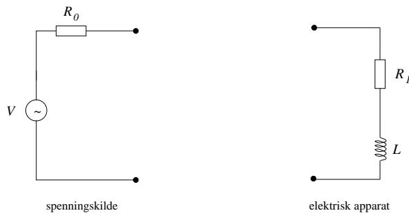
Vi tenker oss nå at denne spenningskilden skal brukes til å drive et eller annet elektrisk apparat (f.eks. en motor) som kan beskrives ved en "lastmotstand"  $R_1$  i serie med en induktans  $L$ , se figuren over til høyre. Med apparatet koblet til spenningskilden har vi dermed følgende krets:
