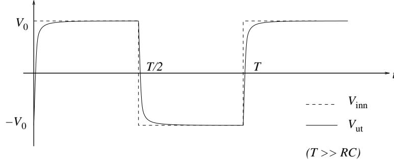
Med andre ord, utgangsspenningen blir omtrent lik inngangsspenningen. Ligger dette resultatet også “innbakt” i Fourier-analysen? Vel, la oss se: Hvis  $\omega \ll 1/RC$ , kan vi, i hvert fall for endel av de laveste verdiene av  $n$ , neglisjere faktoren  $(n\omega RC)^2$  i forhold til 1. Det betyr at for lave verdier av  $n$  er
