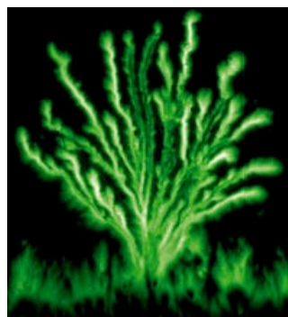
Magnettråder: Med et magneto-optisk mikroskop kan man se magnetfeltet trengende inn i superlederen. Disse magnettrådene er typisk 200 nm i diameter! (Løvhaug, 2003).
