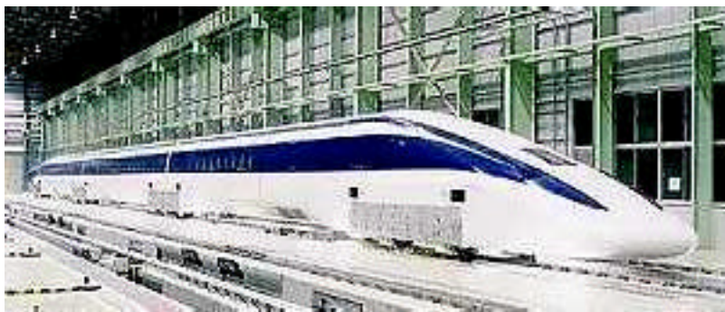
Yamanashi MLX01 MagLev tog: Praktisk bruk av Meissner-effekten (hentet fra http://www.superconductors.org/Uses.htm ).
