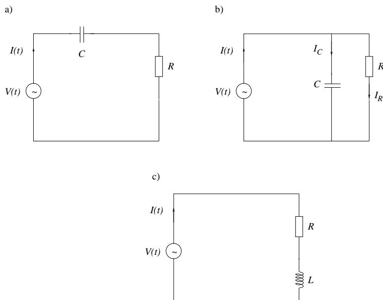
NB: Vi antar i denne typen oppgaver, med mindre noe annet er spesifisert, at spenningskilden har vært koblet til kretsen så lenge at vi har stasjonære forhold. I matematisk forstand betyr det at vi kun er ute etter den såkalte partikulærlosningen av differensialligningen for  $I$  (eller  $Q$ ) i hvert enkelt tilfelle. Når  $V(t)$  svinger harmonisk med vinkelfrekvens  $\omega$ , som her, vil  $I$  og  $Q$  også svinge harmonisk med samme vinkelfrekvens.
