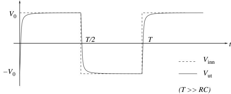
Med andre ord, utgangsspenningen blir omrent lik inngangsspenningen. Ligger dette resultatet også "innbakt" i Fourier-analysen? Vel, la oss se: Hvis  $\omega \ll 1/RC$ , kan vi, i hvert fall for endel av de laveste verdiene av  $n$ , neglisjere faktoren  $(n\omega RC)^2$  i forhold til 1. Det betyr at for lave verdier av  $n$  er
