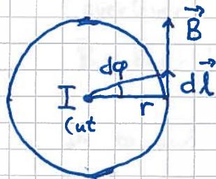
"Bit" av sirkelen:  $dl = r \cdot d\phi \cdot \hat{\phi}$ , der  $\hat{\phi}$  er enhetsvektor tangentielt til sirkelen
