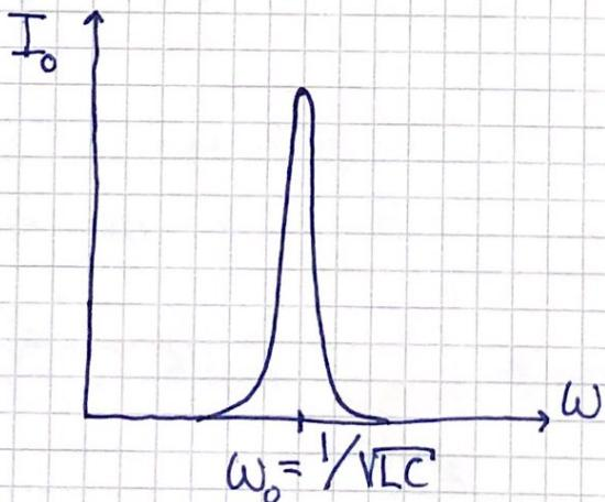
Med voltmeter måles spenningene  $V_R = RI$  og  $V_C = Q/C$  over hhv R og C, og dermed kan vi måle  $I_0(\omega)$  og  $Q_0(\omega)$
