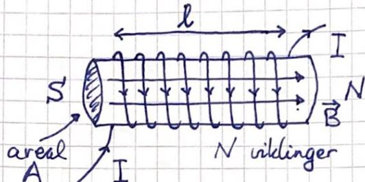
En strøm  $I$  i ledet skaper et magnetfelt  $\vec{B}$  som er omtrent konstant inne i spolen, når denne er tett viklet og lang. Spolen blir som en starmagnett, med en nordpol  $N$  og en sørpol  $S$ . Magnetisk feltstyrke inne i spolen er
