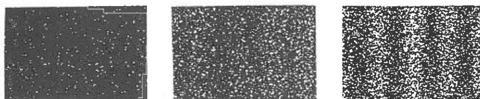
Fig. 1.4 Interferensmønsteret i et dobbeltspaltforsøk kommer fram først når mange elektroner er blitt detektert. Antall registreringer (hvite prikker) øker mot høyre.
