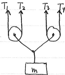
Med pakken i ro er det åpenbart at  $T_1 = T_2 = T_3 = T_4 = T =$  felles snordrag for hele tauet. (Med tilnærmet masseløst tau <sup>og trinser</sup> gjelder dette selv om  $m$  akselereres oppover eller nedover.) Og for å holde tauet i ro må du dermed trekke nedover med kraft lik  $T$ .
