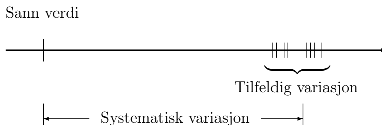
Figur 4.2: Illustrasjon av forskjellen mellom tilfeldige og systematiske feil.
