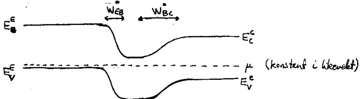
Aktiv modus:  $V_{EB} > 0 \Rightarrow W_{EB} < W_{EB}^*$
