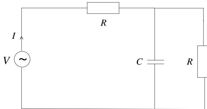
For "tilstrekkelig lave" verdier av vinkelfrekvensen  $\omega$  (i dette tilfellet:  $\omega \ll 1/RC$ ) kan vi uten mye regning men med god tilnærming fastslå at strømmen  $I$  må bli 2 mA, og at den svinger i fase med spenningen  $V$ . Forklar hvorfor. Bestem deretter strømstyrken  $I$  (både absoluttverdi og fasevinkel) dersom vinkelfrekvensen er  $1000 \text{ s}^{-1}$ . For hvilken verdi av  $\omega$  får vi størst faseforskyvning mellom  $V$  og  $I$ ?
