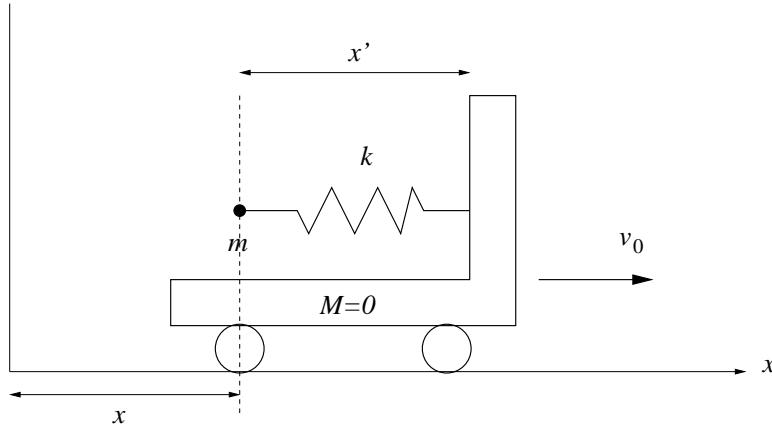
Ei vogn med neglisjerbar masse ( $M \simeq 0$ ) triller med konstant hastighet  $v_0$  på et horisontalt underlag. Til vognen er det festet ei masseløs fjær (fjærkonstant  $k$ ) med ei kule med masse  $m$  i enden av fjæra.
