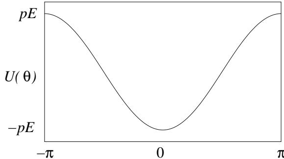
Vi har minimal  $U$ , og følgelig stabil likevekt for  $\theta = 0$ , dvs for dipolen orientert slik at  $\mathbf{p}$  er parallel med  $\mathbf{E}$ . Konklusjon: Elektriske dipoler, f.eks. polare molekyler i et dielektrikum, retter seg inn langs det ytre ("påtrykte") elektriske feltet.
