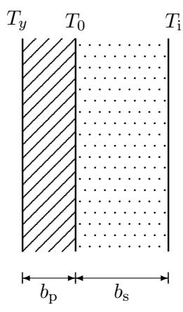
$b_p = 2 \text{ cm}$  panel og  $b_s = 3.5 \text{ cm}$  styropor.
