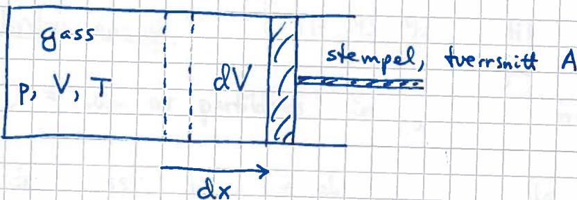
Arbeid utført av gassen på omgivelsene når  $V \rightarrow V + dV$ :
