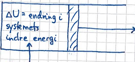
$\Delta W = \text{arbeid utført av systemet på omgivelsene}$
