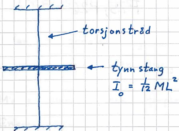
Torsjonstråden motsetter seg vridning. Virker på stanga med dreiemoment prop. med vridningsvinkelen,
