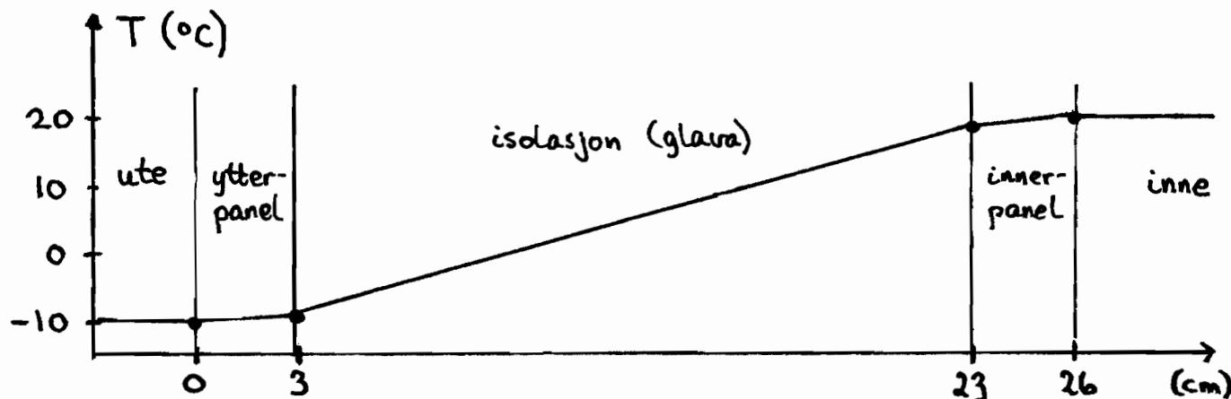
Merk: Størst temperaturgradient,  $dT/dx = P/\lambda A$ , gjennom materialet som isolerer best (minst  $\lambda$ ).
