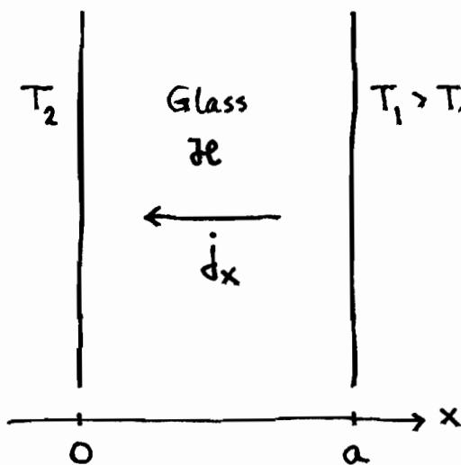
Eksperimentelt finnes (som ventet?) at  $j_x$  er proporsjonal med  $\Delta T = T_1 - T_2$ , motsatt rettet  $\Delta T$ , og omvendt prop. med tykkelsen  $a$ :
