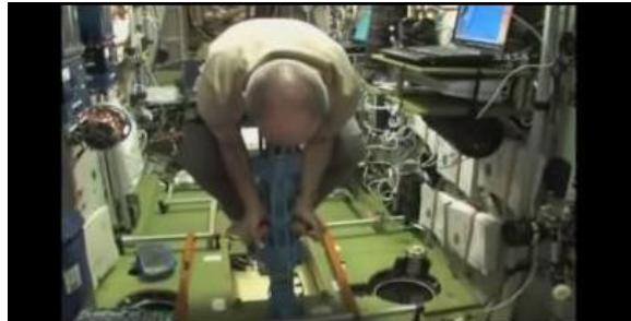
Stolen i ISS har masse 42 kg og svinger opp og ned som en enkel harmonisk oscillator med periode 0.79 s uten astronauten på. Med astronauten på er perioden 1.36 s. Hva er astronautens masse?
