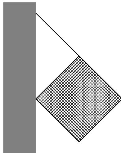
10. Ei kvadratrisk plate med masse 3.6 kg er festet til en vertikal vegg med ei tilnærmet masseløs snor (se figuren over, til høyre). Det er tilstrekkelig med friksjon mellom vegg og plate til at plata blir hengende som vist i figuren, med tyngdepunktet i samme høyde som det hjørnet som har kontakt med vegg. Snora er parallell med platas ene sidekant. Hva er snordraget  $S$ ?
