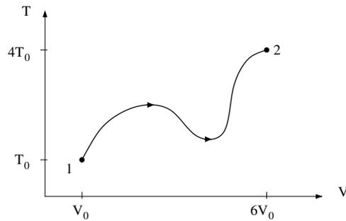
Ett mol neongass (enatomig ideell gass) gjennomgår en reversibel prosess fra en tilstand 1, med temperatur  $T_0 = 200$  K og volum  $V_0 = 3.0$  L, til en tilstand 2, med temperatur  $4T_0$  og volum  $6V_0$ . Hva er gassens entropiendring  $\Delta S = S_2 - S_1$ ?
