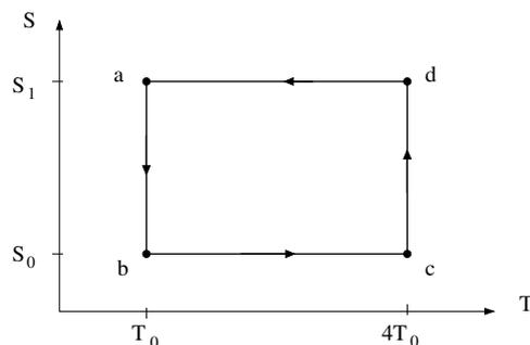
Figuren viser en reversibel kretsprosess for en varmpumpe i et  $(S, T)$ -diagram. Temperaturen  $T_0$  er 200 K. Hva er varmpumpas effektivitet?
