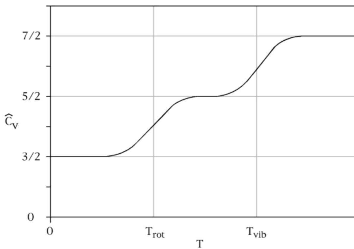
I figuren ser du varmekapasiteten  $C_V$  for hydrogen som funksjon av temperatur  $T$ . Legg merke til at ved temperaturene  $T_{\text{rot}}$  og  $T_{\text{vib}}$  "hopper" varmekapasiteten.
