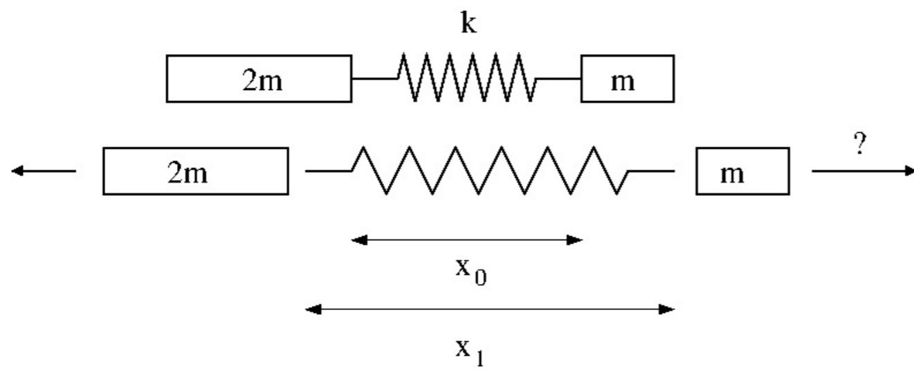
To klosser med masse hhv 30 og 15 g ligger på et friksjonsfritt bord på hver sin side av ei (masseløs) spent fjær med fjærkonstant 45 N/m. Når fjæra utløses, forlenges den fra 5.0 cm til 8.5 cm, og de to massene skyves i hver sin retning. Hva blir hastigheten til klossen med masse 30 g? (Tips: Impuls- og energibevarelse.)
