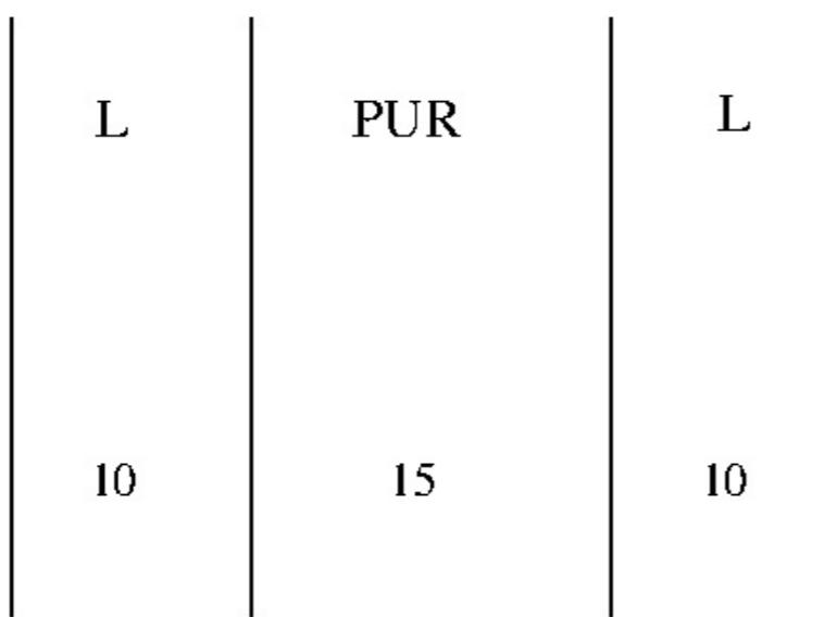
En Leca Isoblokk består av to lag med lecastein (L) adskilt av et lag med polyuretanskum (PUR). Hvert lag med lecastein har tykkelse 10 cm, og PUR-laget har tykkelse 15 cm. Lecastein og PUR har varmeledningsevner hhv 0.23 og 0.024 W/Km. Hvor stor er varmemotstanden til en vegg på 1.0 kvadratmeter, bygget med slike Leca Isoblokker?
