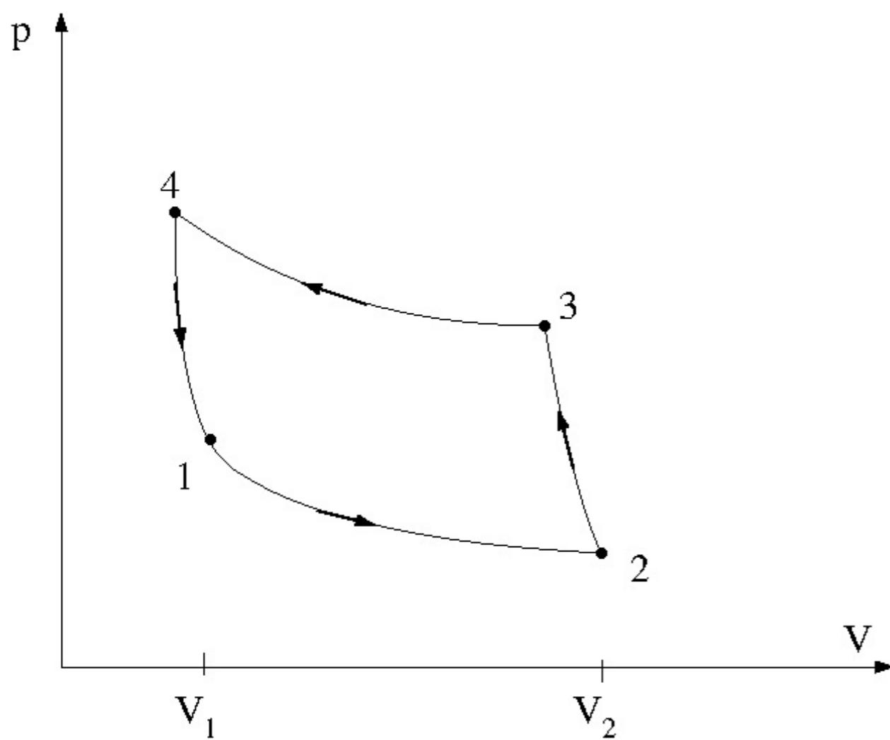
En reversibel Carnot-varmepumpe består av to adiabatiske (isentropiske; 2 til 3, og 4 til 1) og to isoterme (1 til 2, og 3 til 4) delprosesser. Arbeidssubstansen er 1.00 mol av en toatomig ideell gass.
