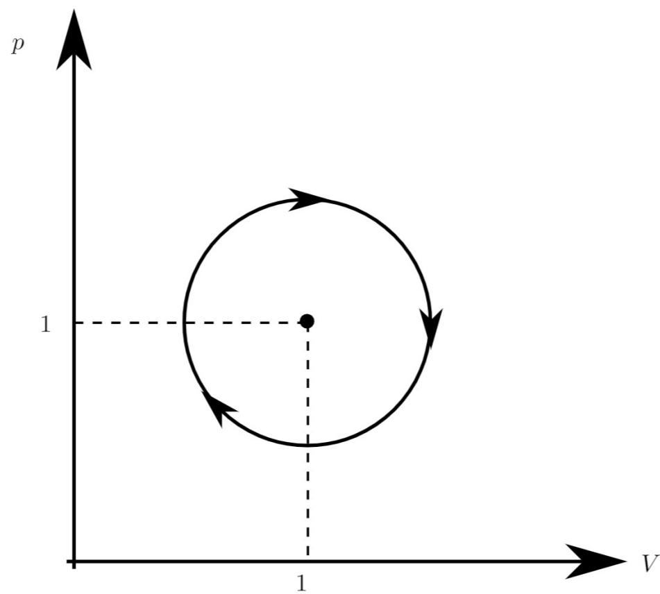
Figuren viser en sirkulær kretsprosess sentrert i punktet  $(p, V) = (1, 1)$  med radius  $R = 1/2$ . Dersom du bruker kretsprosessen som en varmekraftmaskin (dvs omløp med klokka) hva er arbeidet utført per syklus?
