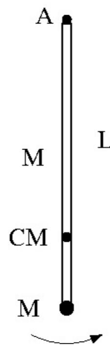
Ei veggklokke inneholder en fysisk pendel som svinger harmonisk fram og tilbake med små utsving fra likevekt. Pendelen består av ei tynn jevntykk stang med masse  $M$  og lengde  $L$ , samt ei lita metallkule (tilnærmet punktmasse) med samme masse  $M$  som stanga, festet i nederste ende av stanga. Pendelen svinger friksjonsfritt om en akse A i øverste ende av stanga, med svingetid 1.00 s. Hva er stangas lengde  $L$ ?
