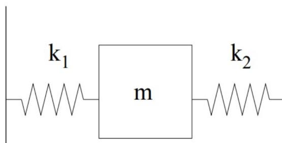
En kloss med masse  $m = 50$  g er festet til to ideelle masseløse fjærer som vist i figuren. Fjærene har fjærkonstanter henholdsvis  $k_1 = 60$  N/m og  $k_2 = 85$  N/m. Klossen trekkes horisontalt litt ut fra sin likevektsposisjon og slippes. Med hvilken periode (svingetid) svinger nå klossen fram og tilbake?
