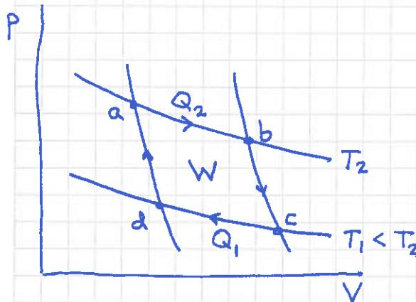
a → b: isotherm utvidelse ved  $T_2$ ,  $Q_2 > 0$ b → c: adiabatisk → fra  $T_2$  til  $T_1$ ,  $Q=0$ c → d: isotherm kompresjon ved  $T_1$ ,  $Q_1 < 0$ d → a: adiabatisk → fra  $T_1$  til  $T_2$ ,  $Q=0$
