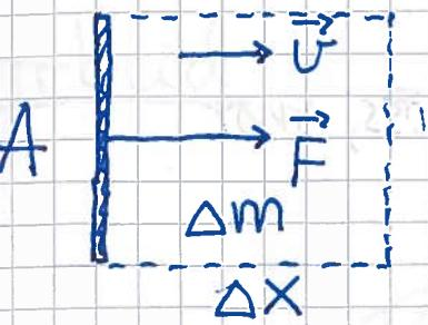
Må dytte med kraft  $F$  for å holde konstant fart  $v$ , fordi luftmassen  $\Delta m = g \Delta V = gA \Delta x$  endrer sin fart fra 0 til  $v$  i løpet av  $\Delta t = \Delta x/v$
