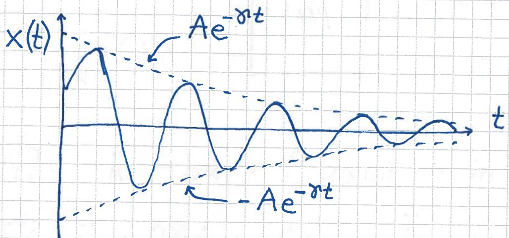
dvs svingning med amplituden,  $A e^{-\gamma t}$ , som avtar eksponentielt med  $t$ ; etter en "karakteristisk" tid  $\tau = 1/\gamma$  er amplituden redusert til  $A/e \approx 0.37 A$ .
