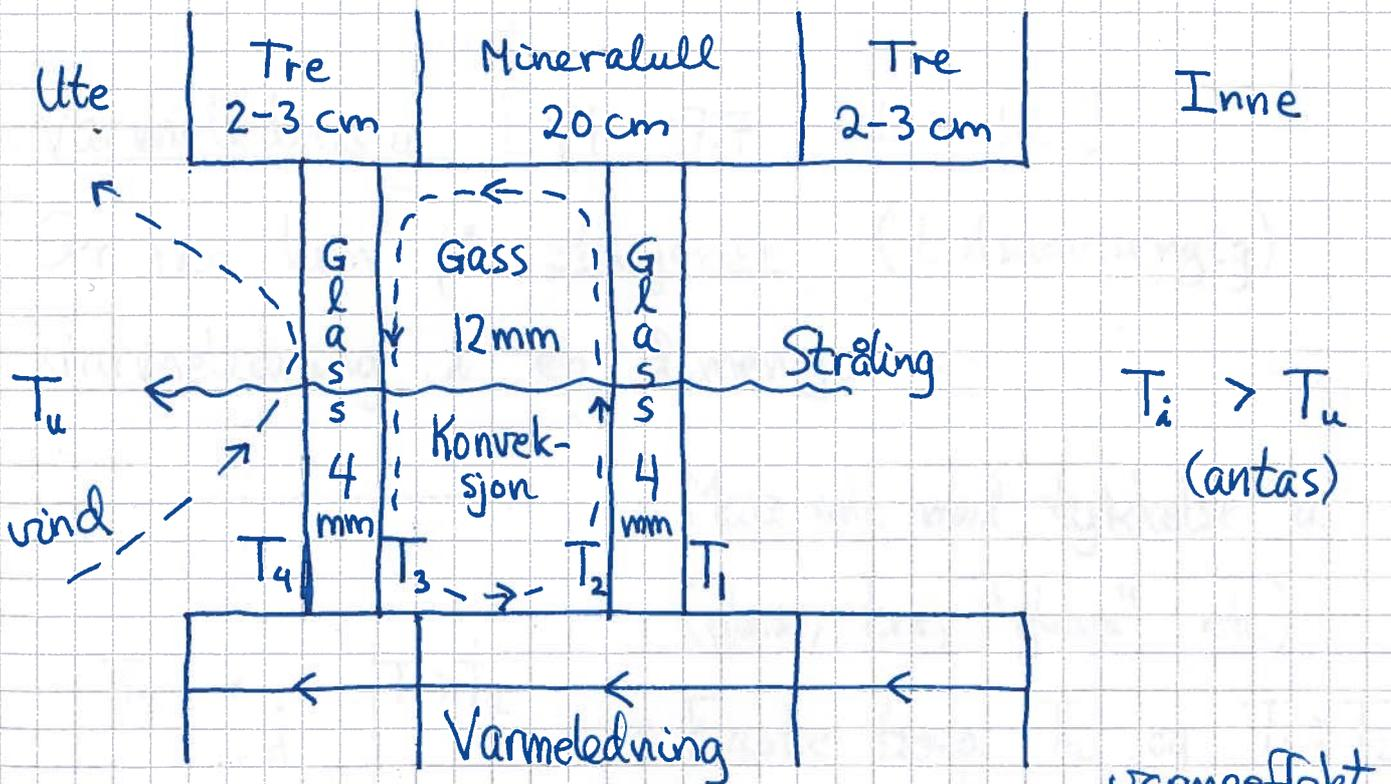
Varmestrømtetthet  $\stackrel{\text{def}}{=} \overbrace{\text{overført varme pr tidsenhet}}^{\text{varmeeffekt}} \text{ og pr flateenhet}$
