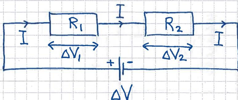
Ladningsbevarelse  $\Rightarrow$  Lik elektrisk strøm  $I$  gjennom  $R_1$  og  $R_2$
