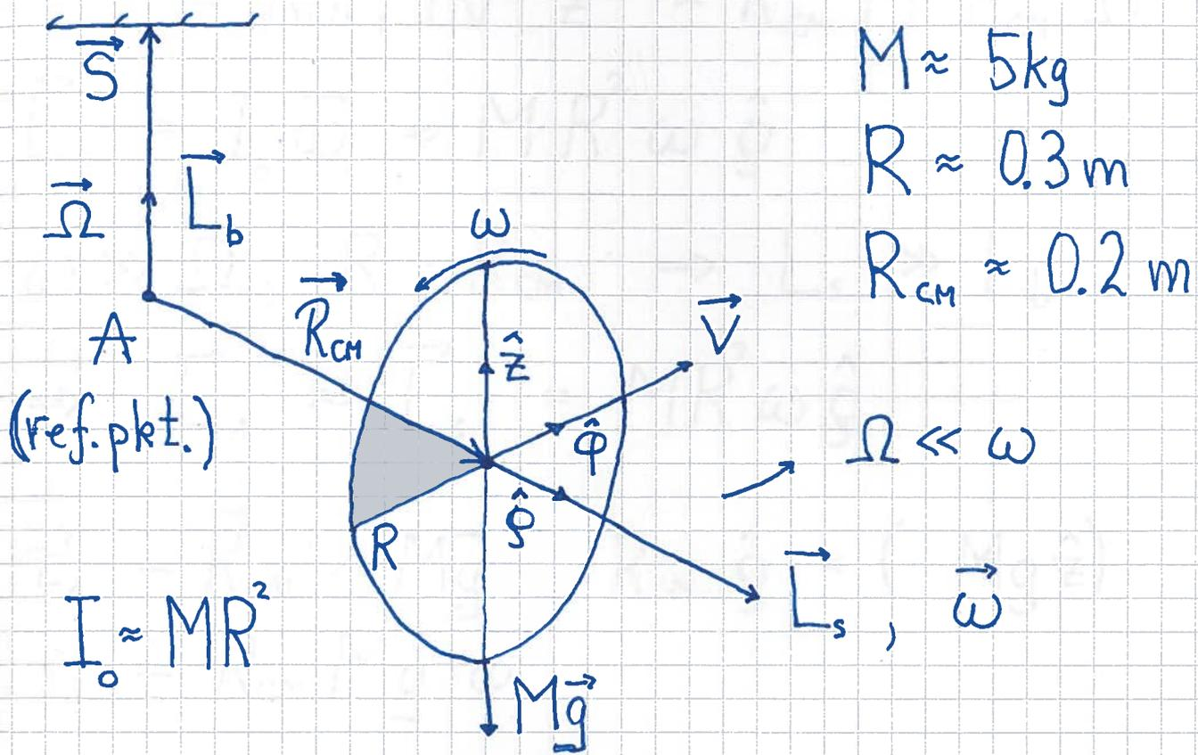
Exp:  $T_\Omega = \frac{2\pi}{\Omega} \approx 5 \text{ s}$  når hjulet settes i rotasjon for hånd.
