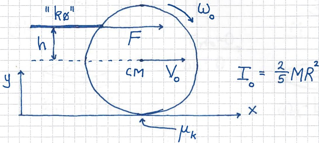
Kortvarig støt med køen,  $\Delta t \approx 0$ , i høyde  $h$  over senterlinja med kraft  $F \gg f$  ;  $f =$  friksjonskraft fra underlaget.
