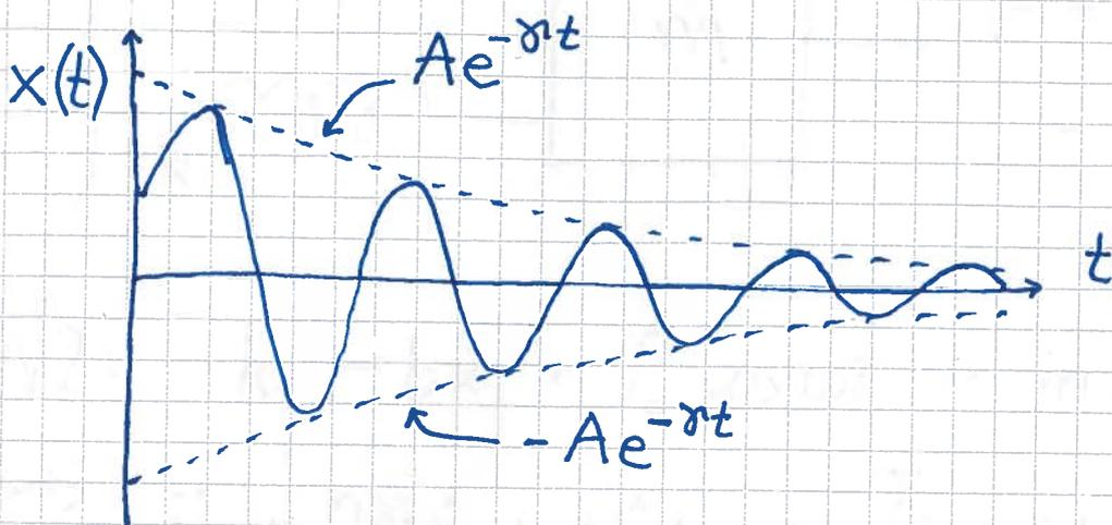
dvs svingning med amplitude,  $A e^{-\gamma t}$ , som avtar eksponentielt med  $t$ ; etter en "karakteristisk" tid  $\tau = 1/\gamma$  er amplituden redusert til  $A/e \approx 0.37 A$ .
