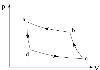
Figuren viser en reversibel kretsprosess der arbeidssubstansen er en gass. Hva kan du si om netto varme som tilføres arbeidssubstansen pr syklus (fra omgivelsene) i denne kretsprosessen?
