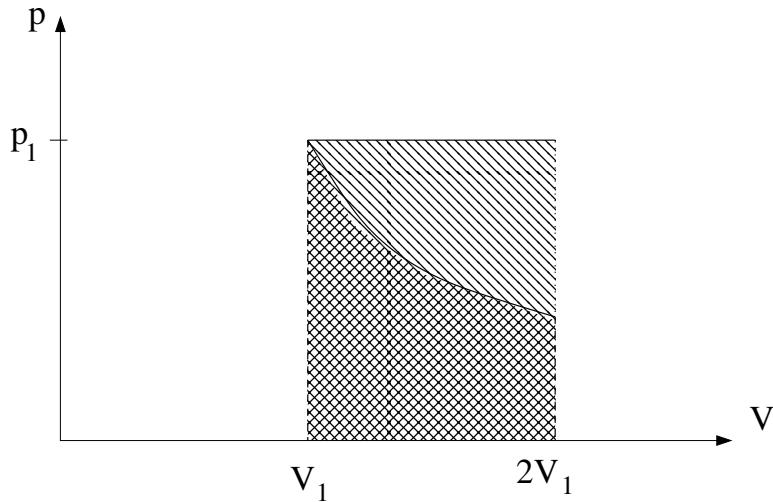
3) Tilførsel av varme ved konstant trykk betyr at gassen utfører et positivt arbeid på omgivelsene (f.eks. hele det skraverte arealet i forrige oppgave). Da blir gassens økning i indre energi mindre enn tilført varme.
