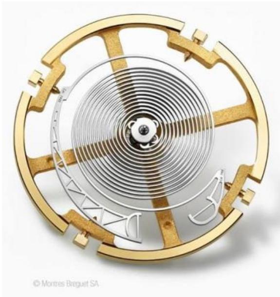
Prinsippet for en mekanisk klokke er et hjul med treghetsmoment  $I$  festet til ei spiralfjær som virker på hjulet med et dreiemoment  $\tau$  som er proporsjonalt med hjulets dreining  $\theta$  (målt i radianer, selvsagt) relativt spiralfjæras likevektsstilling,  $\tau = -D\theta$ . Her er  $D$  spiralfjæras torsjonsstivhet. Hva blir hjulets svingetid  $T$  for periodiske svingninger omkring likevektsstillingen?
