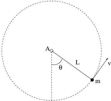
Figuren til venstre viser en såkalt matematisk pendel, bestående av ei kule (punktmasse) med masse  $m$  i enden av ei masseløs stang med lengde  $L$ . Stanga kan svinge uten friksjon omkring festepunktet (A), slik at kula følger en sirkelbane med radius  $L$ . Kulas bevegelse er bestemt ved ligningen
