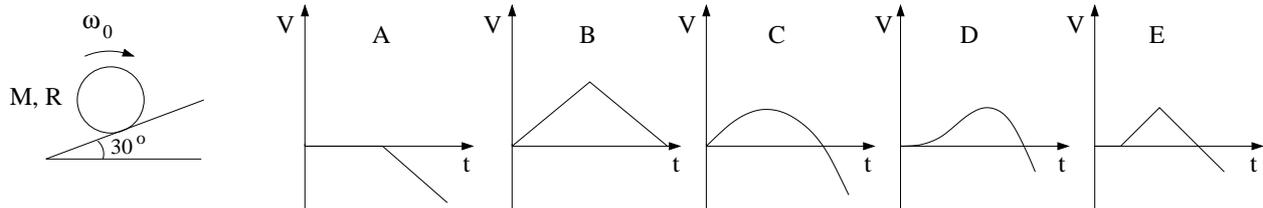
15) Ei roterende kompakt skive med masse  $M$  og radius  $R$  settes forsiktig ned på et skråplan ved tidspunktet  $t = 0$ , med vinkelhastighet  $\omega_0$  og hastighet  $V_0 = 0$ . Kinetisk friksjonskoeffisient mellom skive og underlag er  $\mu_k = 1/\sqrt{3}$ . Skråplanets helningsvinkel er  $30^\circ$ . Hvilken graf viser skivas hastighet  $V$  som funksjon av tiden  $t$ ? (Positiv retning oppover skråplanet.)
