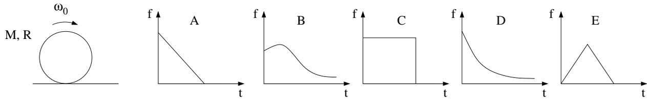
13) Ei roterende kompakt skive med masse  $M$  og radius  $R$  settes forsiktig ned på et horisontalt underlag ved tidspunktet  $t = 0$ , med vinkelhastighet  $\omega_0$  og hastighet  $V_0 = 0$ . Kinetisk og statisk friksjonskoeffisient mellom skive og underlag er henholdsvis  $\mu_k$  og  $\mu_s$ . Hvilken graf ovenfor viser friksjonskraften  $f$  fra underlaget på skiva som funksjon av tiden  $t$ ?
