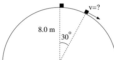
7) En liten kloss glir på et friksjonsfritt halvkuleformet tak med radius 8.0 m. Klossen starter på toppen av taket med svært liten starthastighet. Hva er klossens hastighet når den har glidd en lengde som tilsvarer en vinkel 30° (se figur)? Tips: Energibevarelse.
