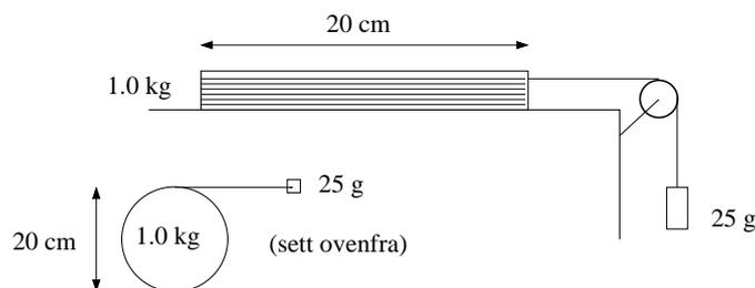
19) Et lodd med masse 25 g er, via ei tilnærmet masseløs snor og trinse, festet til ei kompakt sirkulær skive med masse 1.00 kg og radius 10 cm. Snora er viklet opp rundt skiva, som kan rotere om en fast aksling gjennom massesenteret. Se bort fra alle former for friksjon. Hva blir loddets akselerasjon når dette slippes forsiktig med stram snor?
