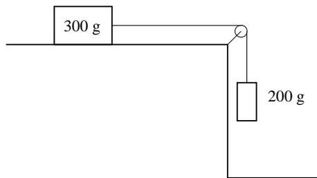
18) En masse på 300 g ligger på et bord og er festet via ei tilnærmet masseløs snor og ei tilnærmet masseløs trinse til en masse på 200 g som kan falle i tyngdefeltet. Kinetisk og statisk friksjonskoeffisient mellom bordet og massen på 300 g er henholdsvis 0.10 og 0.15. Hva blir massenes akselerasjon? (Snora er hele tiden stram.)
