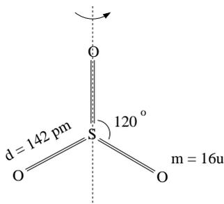
12) Hva er treghetsmomentet, i enheten  $\text{kg m}^2$ , til det plane, symmetriske molekylet  $\text{SO}_3$  med hensyn på en akse som faller sammen med en av bindingene mellom svovel og oksygen? (De tre S=O bindingsslengdene er 142 pm. De tre O=S=O bindingsvinklene er  $120^\circ$ . Oksygen har masse  $16u$ . Atomer kan betraktes som punktpartikler.)
