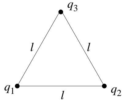
40) Tre punktladninger  $q_1 = 5\mu\text{C}$ ,  $q_2 = -10\mu\text{C}$  og  $q_3 = 15\mu\text{C}$  er plassert i hvert sitt hjørne av en likesidet trekant med sider  $l = 50 \text{ cm}$ . Systemets potensielle energi er
