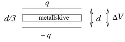
6) To tilnærmet uendelig store parallelle metallplater ligger i innbyrdes avstand  $d$ . De to metallplatene har ladning henholdsvis  $q$  og  $-q$ . Et dielektrikum med permittivitet  $\epsilon > \epsilon_0$  fyller den nederste halvdelen av rommet mellom platene, som vist i figuren. I den øverste halvdelen har vi vakuum. Pilene i figuren angir da feltlinjer for
