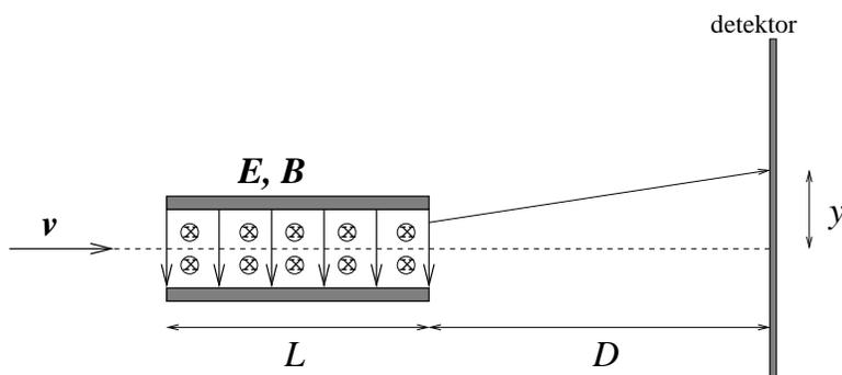
Du holder den elektriske feltstyrken  $E$  konstant gjennom hele eksperimentet. Først setter du  $B = 0$  og registrerer at partiklene avbøyes og treffer detektoren i en avstand  $y$  ovenfor senterlinjen (som er stiplet). Deretter gjentar du forsøket, men nå justerer du verdien av  $B$  inntil partiklene ikke bøyes av.
