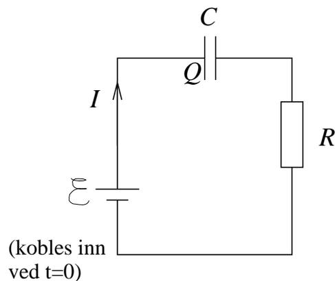
Spenningskilden  $\mathcal{E}$  kobles inn ved tidspunktet  $t = 0$ . Da har vi null ladning på kondensatoren,  $Q(0) = 0$ .
