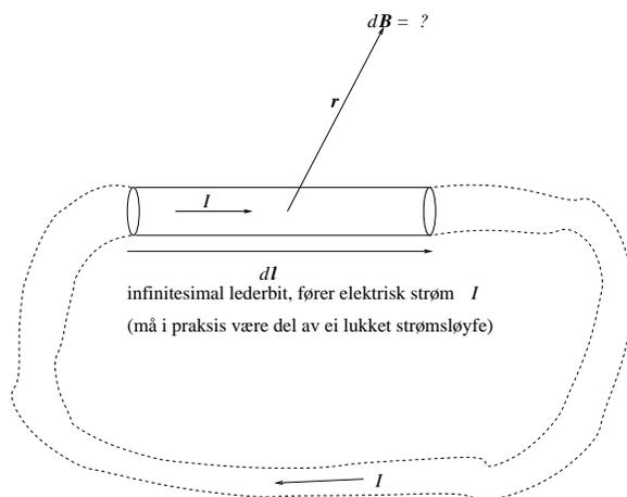
Bidraget  $d\mathbf{B}$  til magnetfeltet i punktet som ligger i en avstand fra lederbiten  $d\mathbf{l}$  gitt ved vektoren  $\mathbf{r}$ , når lederen fører en stasjonær (dvs tidsuavhengig) elektrisk strøm  $I$  er
