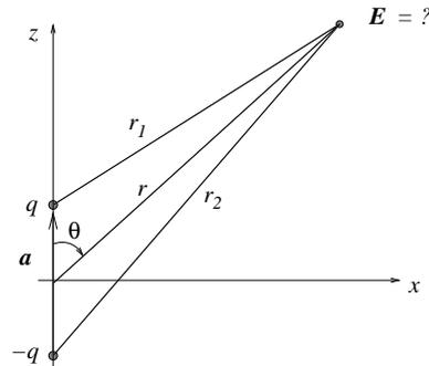
I oppgave 2 i øving 4 betraktet vi en elektrisk dipol, bestående av to punktladninger  $\pm q$  lokalisert på  $z$ -aksen i  $z = \pm a/2$ . Vi viste at potensialet  $V$  i stor avstand ( $r \gg a$ ) fra dipolen er tilnærmet lik
