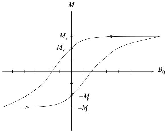
Formen på hysteresekurven vil nå avgjøre om det er snakk om en såkalt "hard magnet" (dvs en permanentmagnet) eller en "bløt magnet" (f.eks. et stykke stål):
