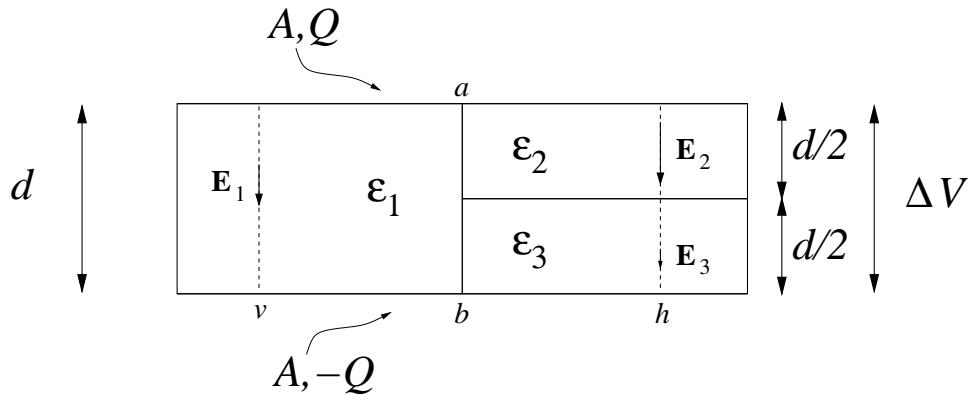
Figuren over viser en parallelplatekondensator der volumet mellom de to metallplatene er fylt med tre ulike dielektrika.
