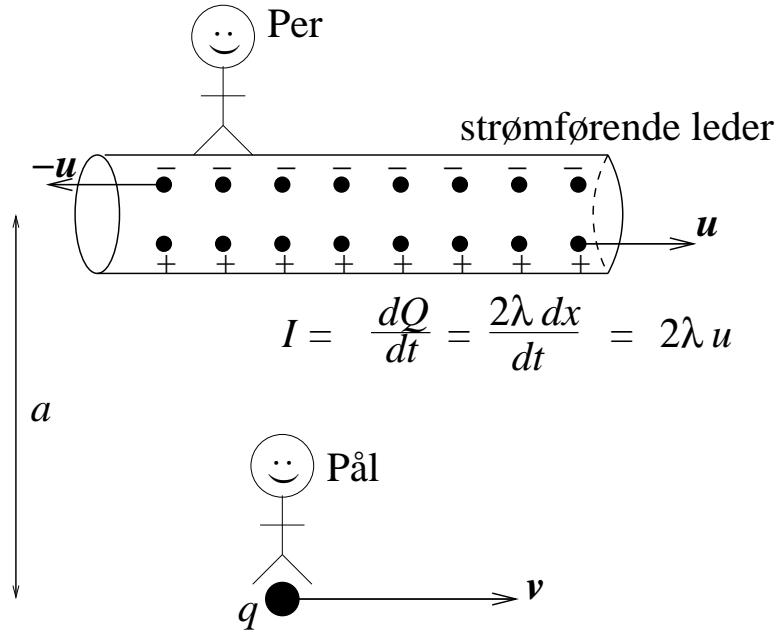
*Per*: Lederen har negativ ladning  $-\lambda$  pr lengdeenhet og positiv ladning  $\lambda$  pr lengdeenhet. Alt i alt er lederen *elektrisk nøytral*.
